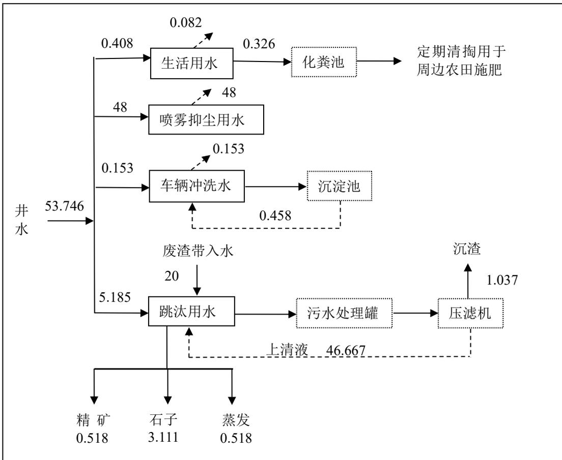
图2-1 项目水平衡图 (单位: m³/d)
