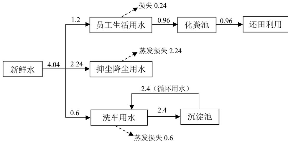
图 2.1 水平衡图 (m<sup>3</sup>/d)
