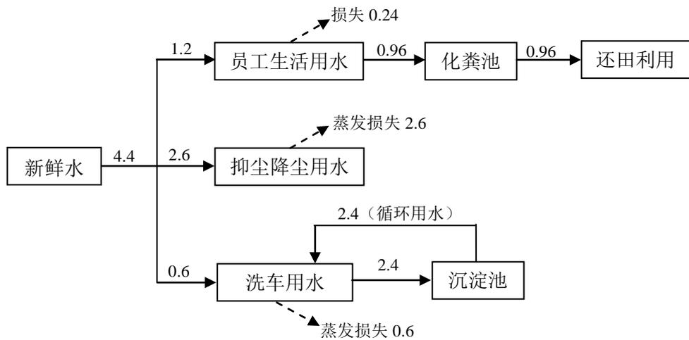
图 2.1 水平衡图 (m<sup>3</sup>/d)
