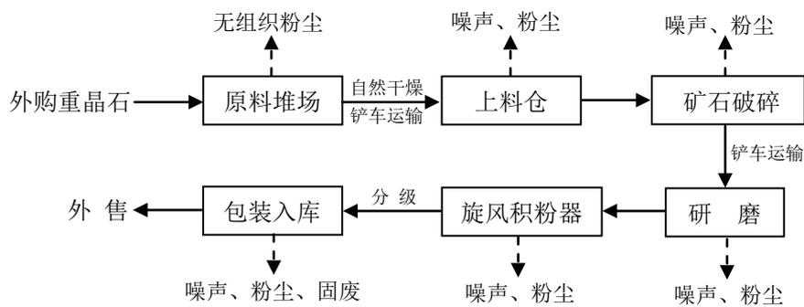
图 2.3 运营期重晶石粉工艺图及产污环节
