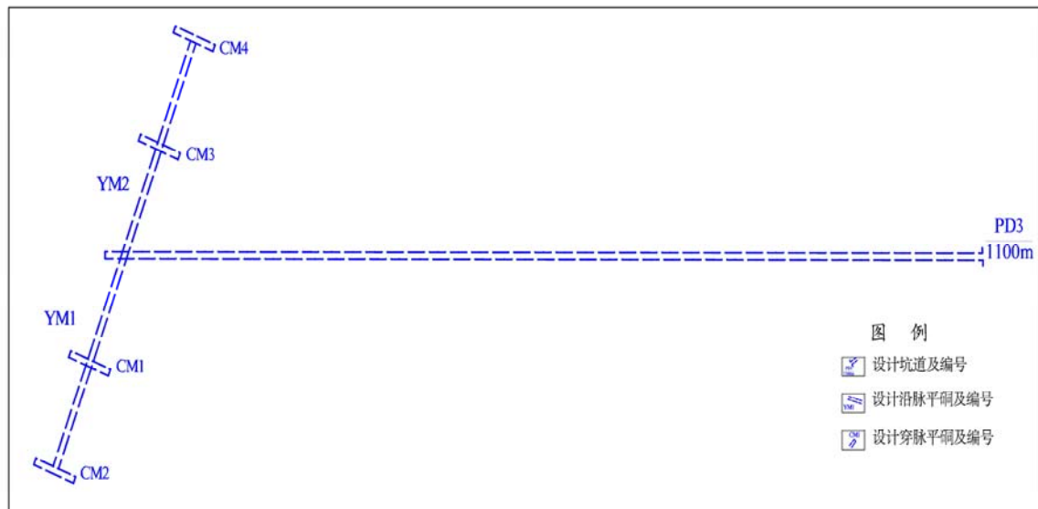
图 4 PD3 坑探工程设计平面图
